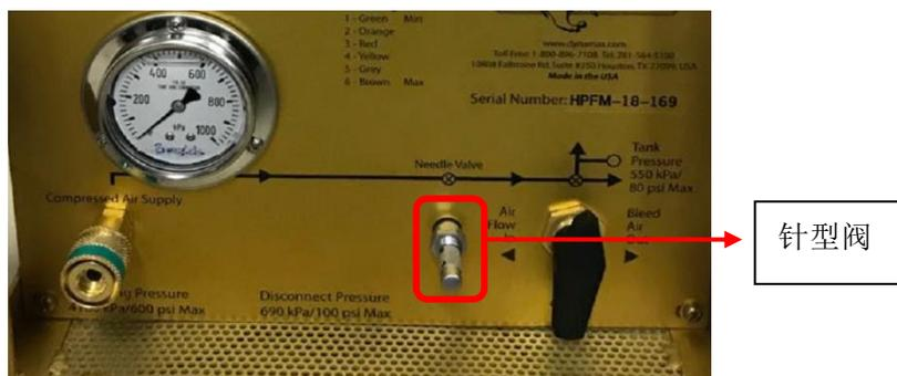
针型阀是改变进气速度的阀门，使用时需将进气速度调节至 5-7KPa/s，并保持在该状态。
